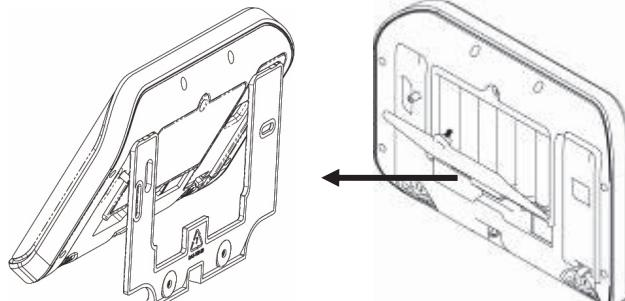
Desserrez la vis inférieure de la centrale ZeroWire afin de permettre le retrait du support mural de l'unité.
