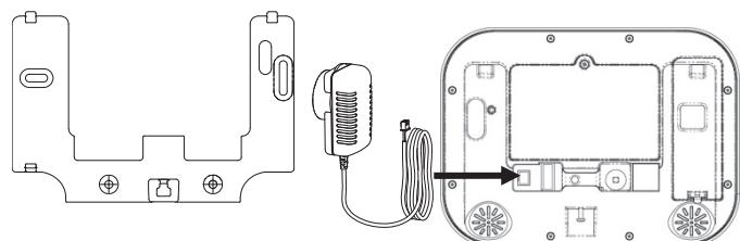
Installez le support au mur à l'aide des vis fournies.
