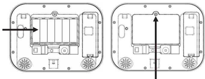
Connectez le câble de la batterie au connecteur de gauche.
